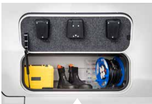
Kältebrückenfreie Stauraumklappen Im Zwischenboden ist alles griffbereit.
